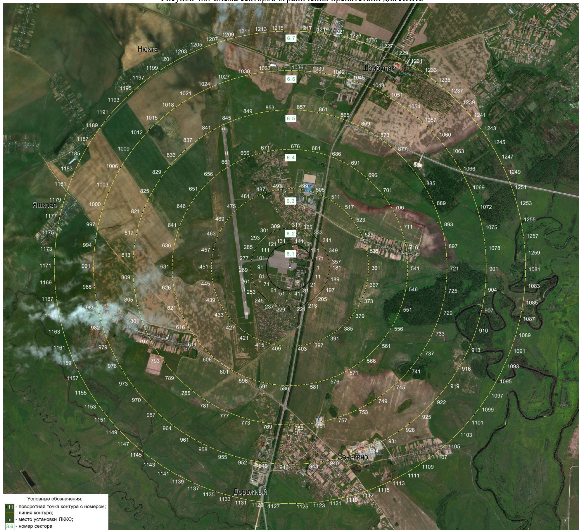
Рисунок 4.6. Схема секторов ограничения препятствий для ЛККС
