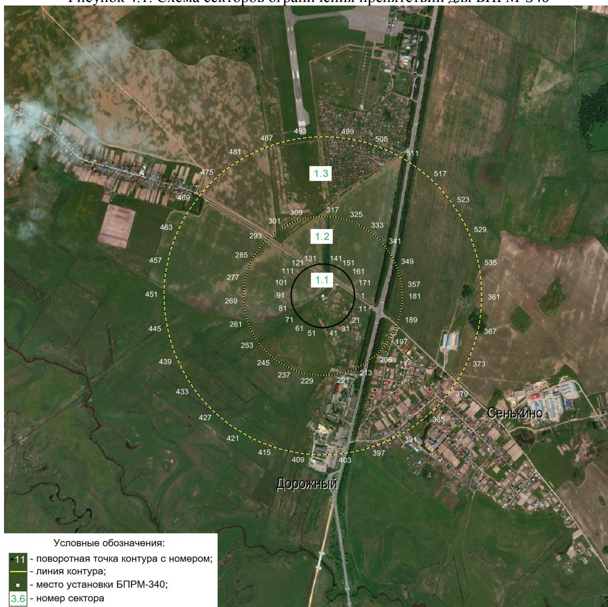
Рисунок 4.1. Схема секторов ограничения препятствий для БПРМ-340
