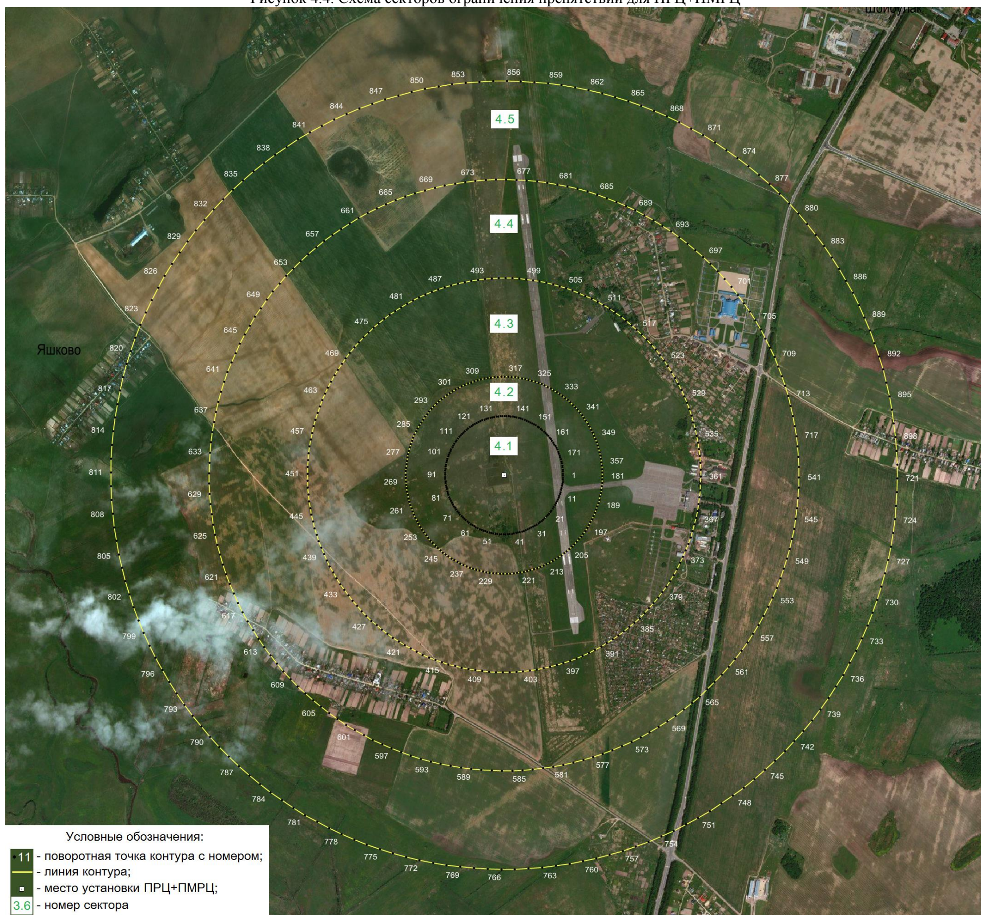
Рисунок 4.4. Схема секторов ограничения препятствий для ПРЦ+ПМРЦ
