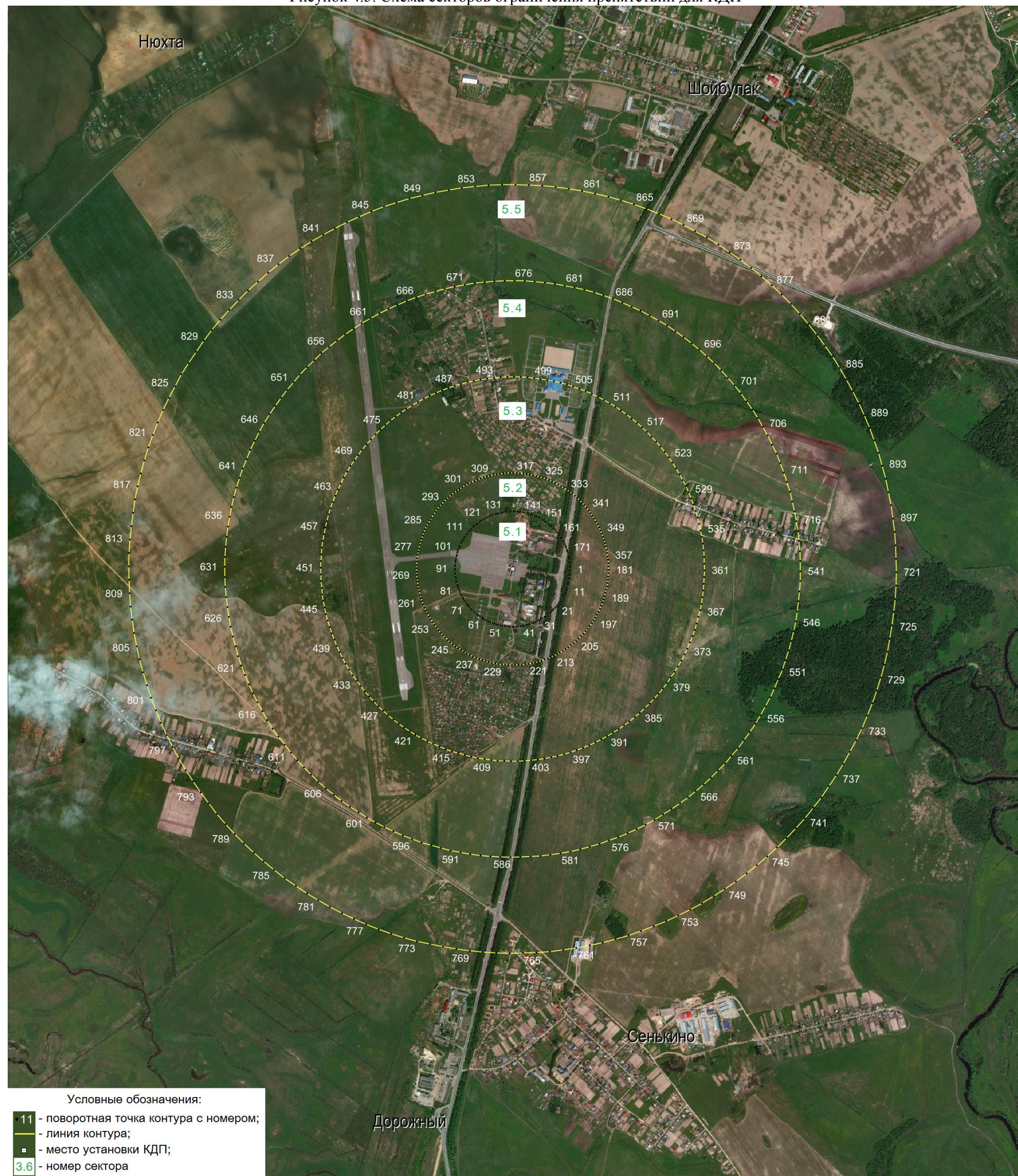
Рисунок 4.5. Схема секторов ограничения препятствий для КДП
