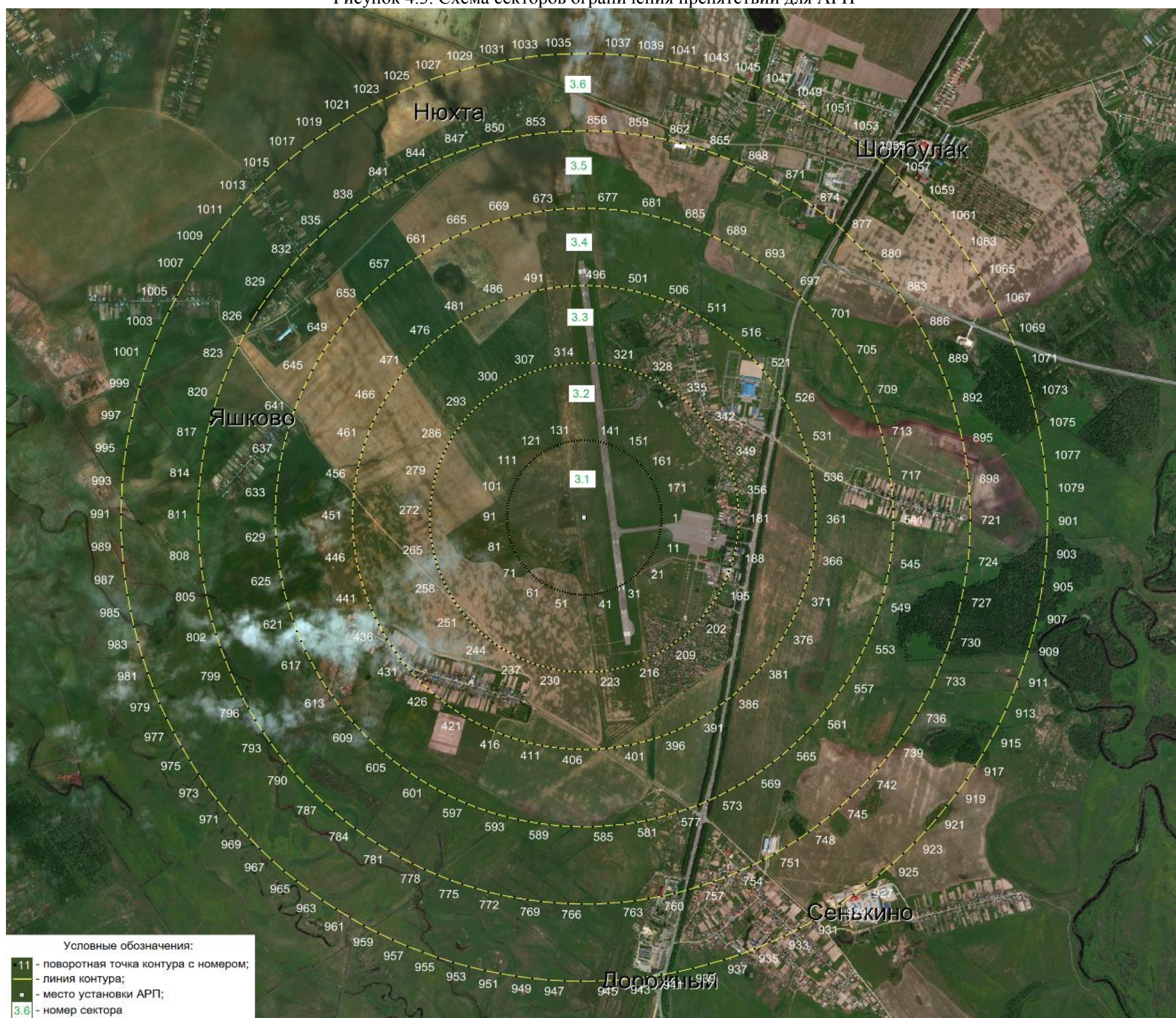
Рисунок 4.3. Схема секторов ограничения препятствий для АРП
